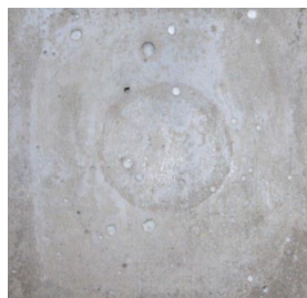
写真5 試験器貼付箇所 (白化) (融雪剤とけい酸塩系表面含浸材塗布試験体)
