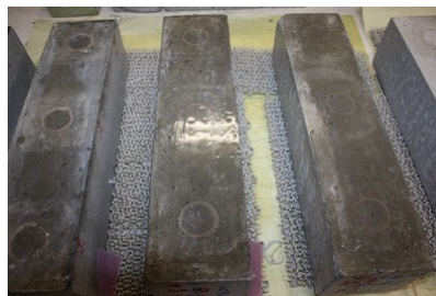
写真2 けい酸塩系表面含浸材塗布状況
