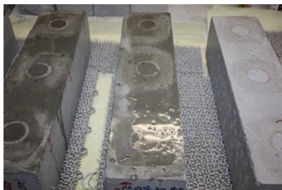
写真1 融雪剤塗布状況
