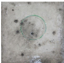
写真4 試験器貼付箇所 (けい酸塩系表面含浸材のみ塗布試験体)
