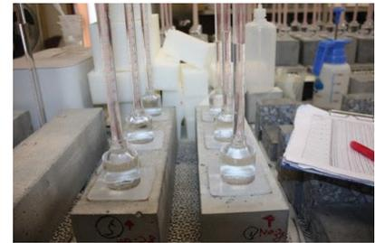
写真3 透水量試験状況-3
