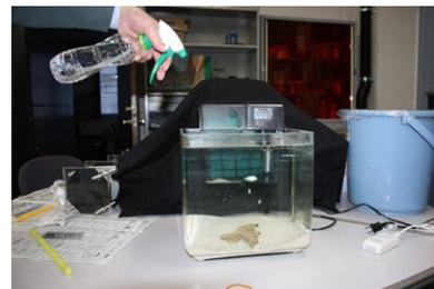
写真4 【反応型 SG】希釈液滴下状況
