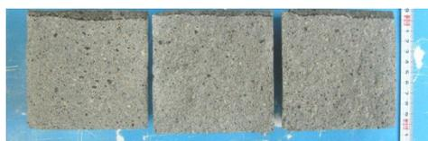
写真6 水の浸透状況（固化型）
