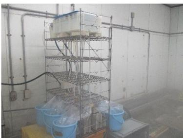
写真7 ひび割れ透水性試験状況-1
