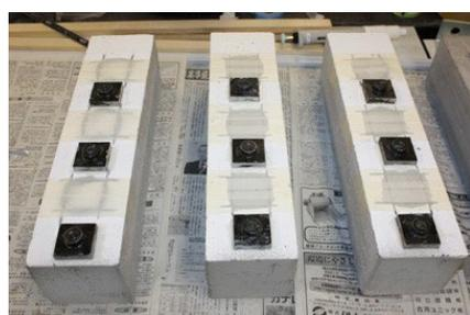
写真14 治具の接着状況（塗装材）-1
