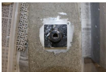
写真 18 治具の接着状況（接着剤）-2
