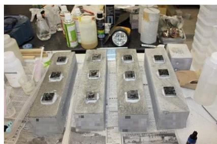
写真 17 治具の接着状況（接着剤）-1
