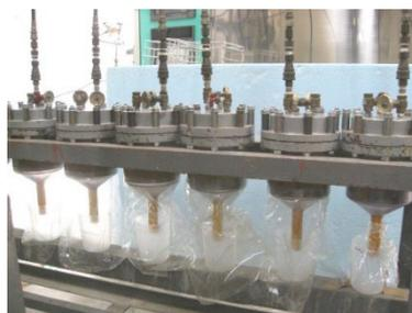
写真2 加圧透水性試験状況-2
