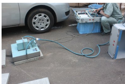
写真3 すべり抵抗試験状況-1
