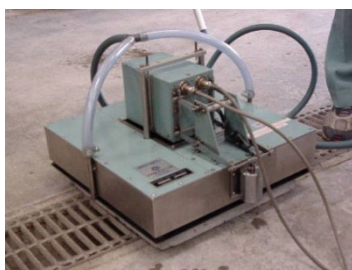
写真4 すべり抵抗試験状況-2
