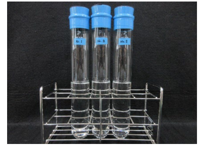
写真 11 乾燥固形分の溶解状況【反応型】 (72時間経過後)
