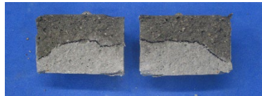
写真 37 水の浸透深さ【無塗布】
