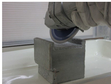
写真 18 粉体試料採取状況-2
