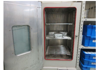
写真5 恒温槽での乾燥状況
