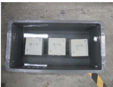
写真 24 塩分溶液への浸漬状況
