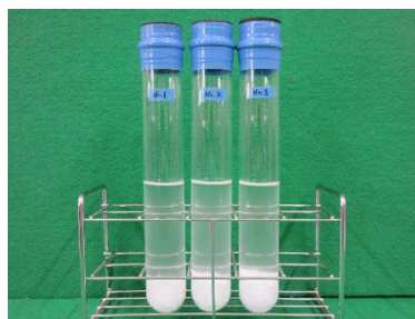
写真 7 乾燥固形分の溶解状況【固化型】 (初期状態)
