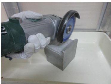
写真 17 粉体試料採取状況-1
