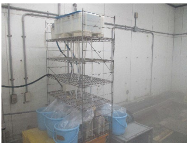
写真 34 ひび割れ透水性試験状況
