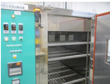
写真 22 促進中性化状況
