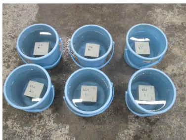
写真 21 吸水率試験状況
