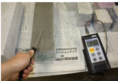
写真4 散水養生後温度測定状況
