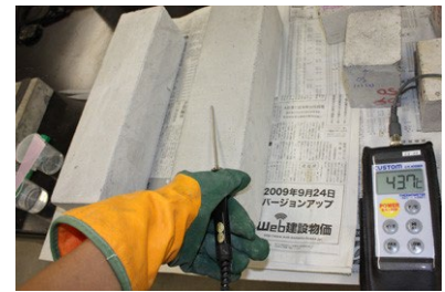
写真3 散水養生前温度測定状況
