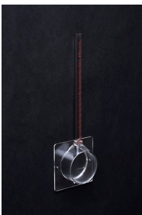
写真1 現場透水量試験器（壁面用）
