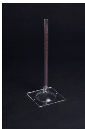
写真2 現場透水量試験器（水平面用）
