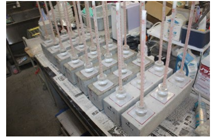
写真3 透水量試験状況
