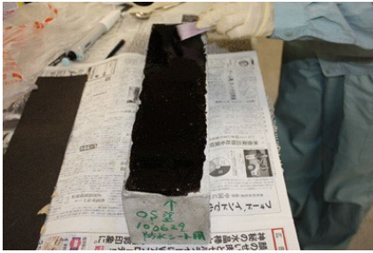
写真1 速乾接着剤塗布状況
