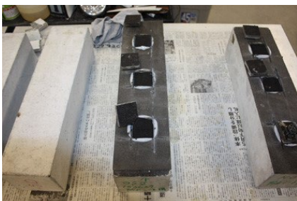
写真5 破断箇所の状況
