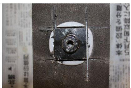
写真4 治具周囲への切り込み
