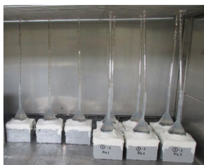
写真10 B社PCM透水量試験状況
