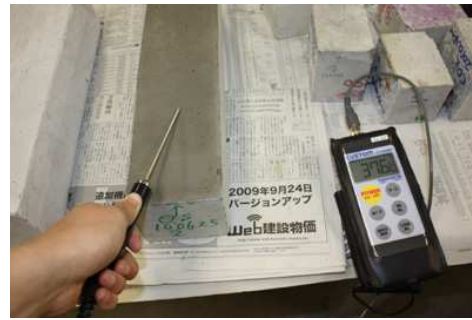
写真4 洗浄・事前散水養生後 (37.6°C)
