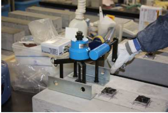
写真4 引張試験機（テクノテスター） で1種類につき各3点引張を 行う
