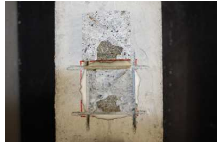
写真5 破断状況 (コンクリート基板で破断)
