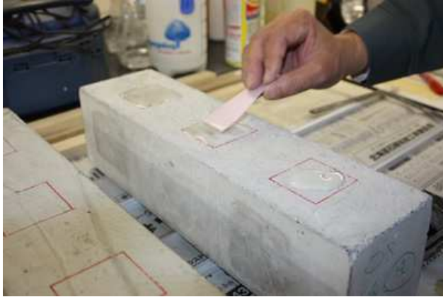
写真1 Osmo 塗布後 (3時間、6時間後)、試験面に接着剤ボンド E200 を塗る
