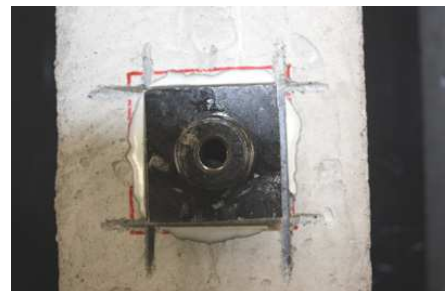
写真3 コンクリート基板位置まで切り込みを入れる
