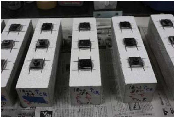
写真5 ジグの周りに基盤までの切り込みを入れる。（約1mm）
