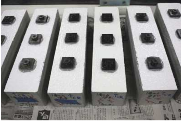
写真4 塗装面にジグ（アタッチメント）を接着させる。
