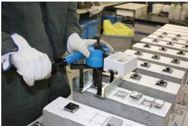
写真6 引張試験機（テクノテスター）を設置し、引張を行う。
