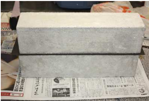
写真2 貼り付けたシートに供試体を載せ、均一に貼り付ける。
