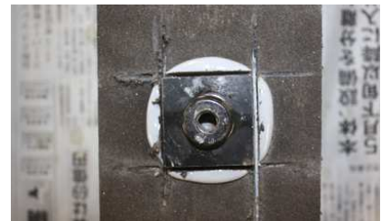
写真3 ジグ（アタッチメント）を貼り付け、基盤のコンクリート位置まで切り込みを入れる。
