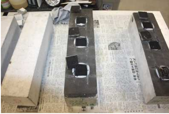
写真4 引張試験機(テクノテスター) で各3点引張を行った。
