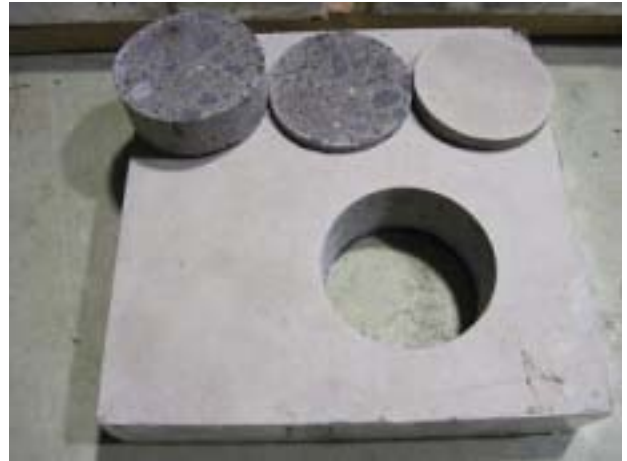
写真 4 コア採取およびスライス (材齢 40 日)
