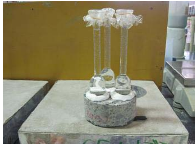
写真 6 透水試験 (深さ 20mm、材齢 46 日)
