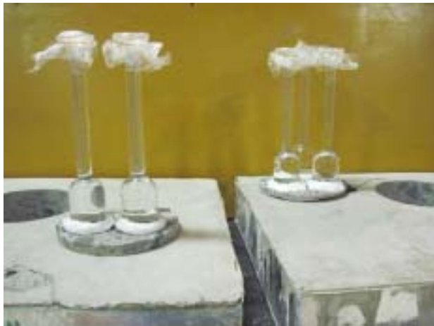
写真 5 透水試験 (深さ 10mm、材齢 45 日)
